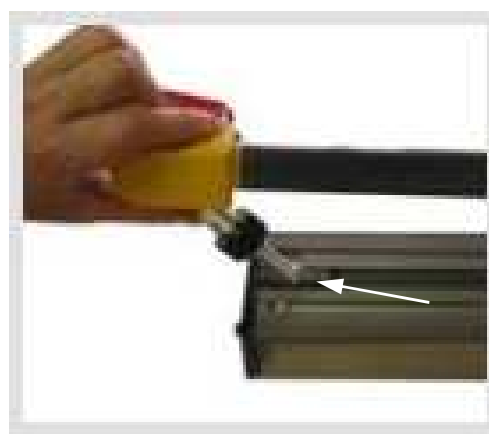
Position Reset correct sur NAJA nouvelle génération Au fond de l'encoche, prévue à cet effet
