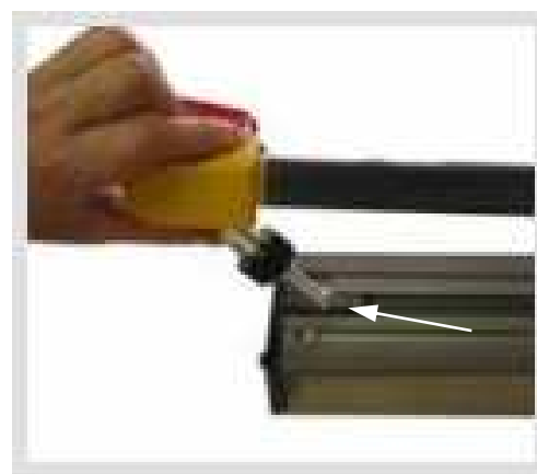
Position Reset correct sur NAJA nouvelle génération Au fond de l'encoche, prévue à cet effet
